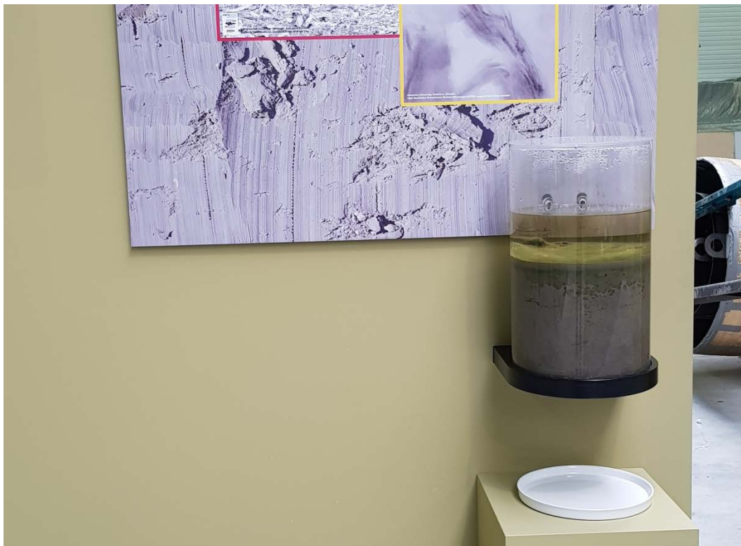
Euridice, Belgien. Demonstrationsforsøg med vandgennemtrængning af lerlag.
