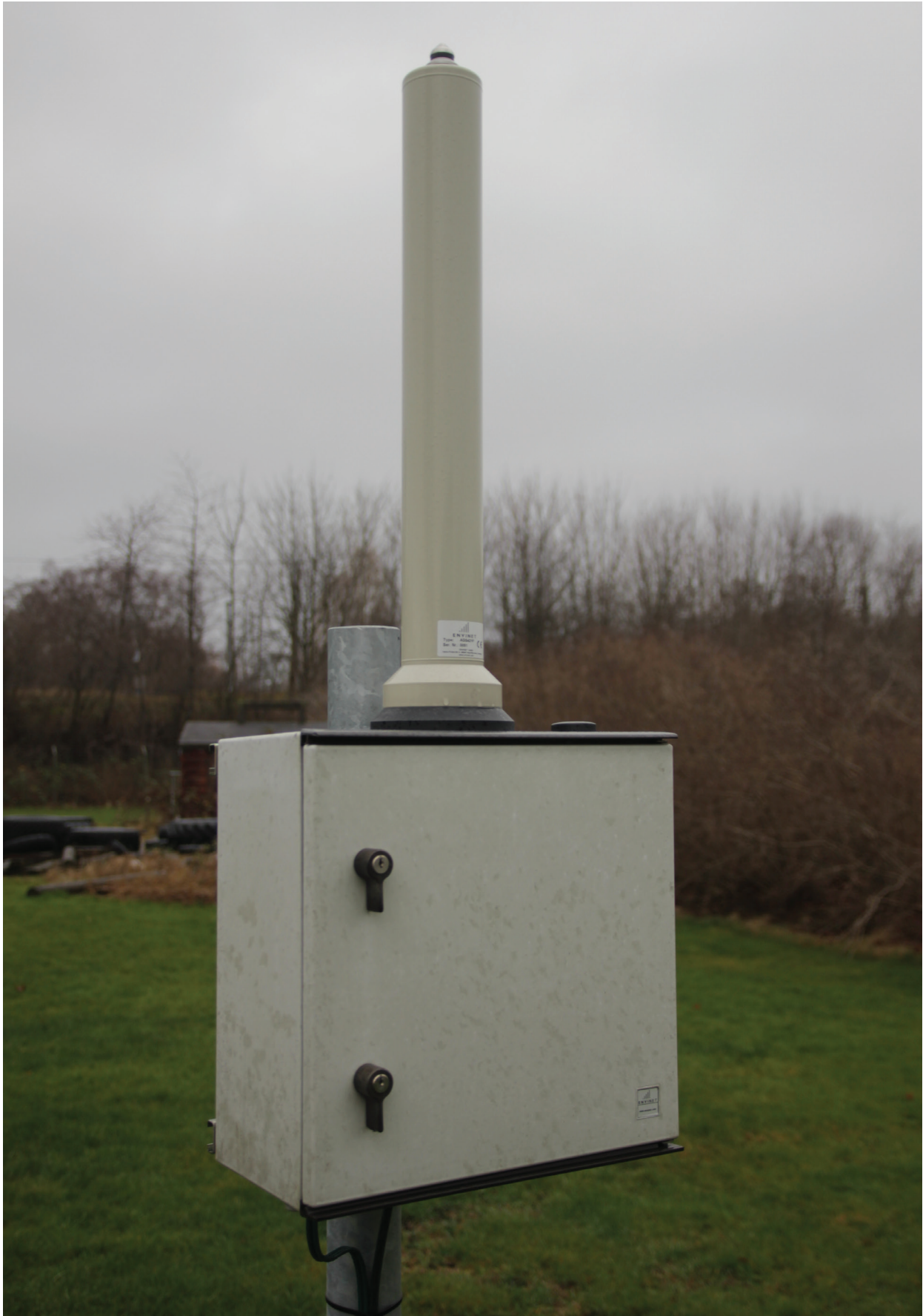
Udledning af radioaktive stoffer til atmosfæren eller vandmiljøet overvåges bl.a. med faste målestationer. Billedet viser et eksempel på en luftmålestation
